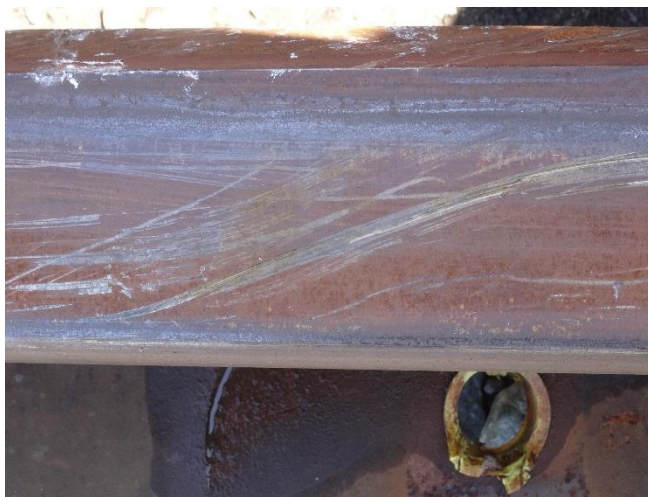
Фиг. 50. Повърхност на главата на левия език на жп стрелка № 20 между 4-ти и 6-ти метър
