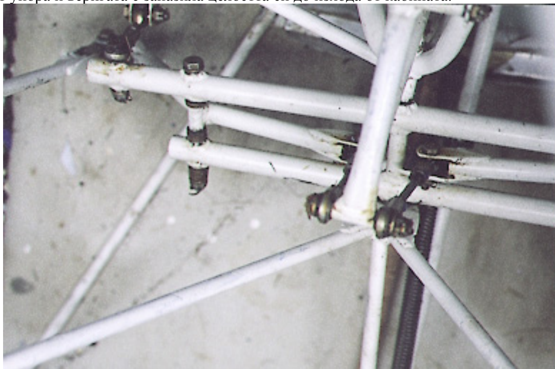
Фиг. 3. Разпределителен възел на основната система за управление.
